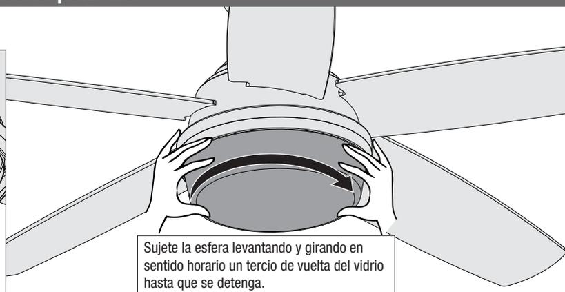
Sujete la esfera levantando y girando en sentido horario un tercio de vuelta del vidrio hasta que se detenga.
