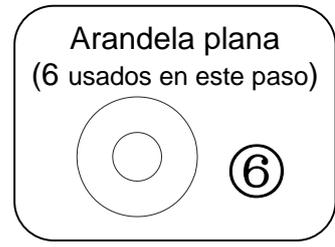
22. Fije el soporte giratorio (J) a la parte superior del poste superior (D) con seis tornillos de 3/4" (3) y seis arandelas (5 y 6). Apriete los tornillos con la llave Allen.
