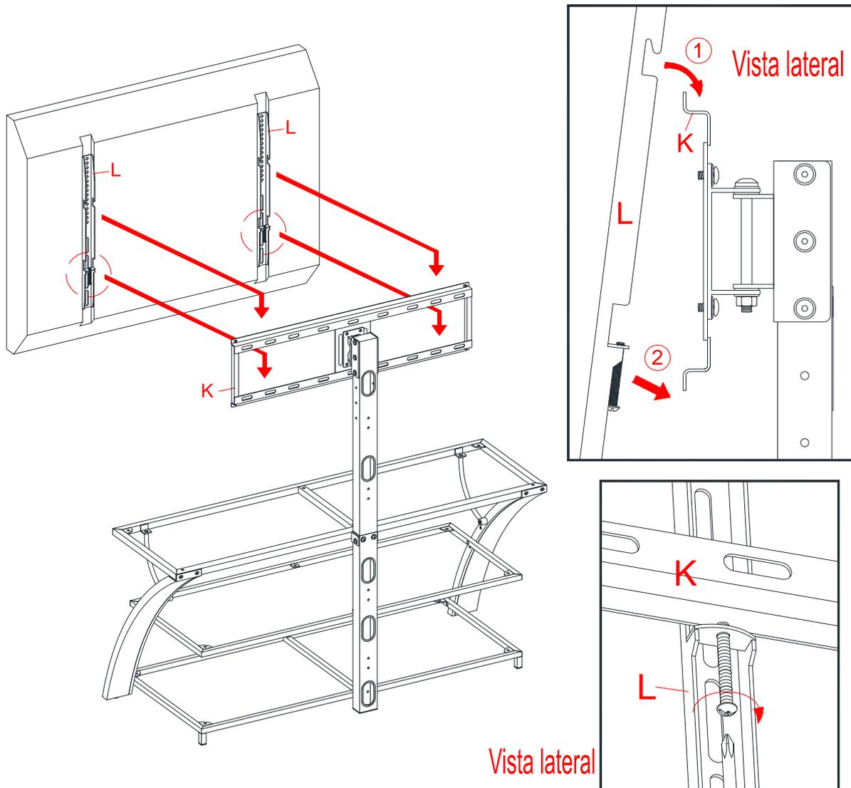
**ASEGÚRESE QUE LOS TORNILLOS ESTEN FIRMES Y ESTAN EN UN ANGULO DE 90 GRADOS Y NIVELADOS PARA VERIFICAR EL MARCO DE MONTAJE ESTA AL NIVEL PREVIO A LA INSTALACIÓN DE LA TV.**
