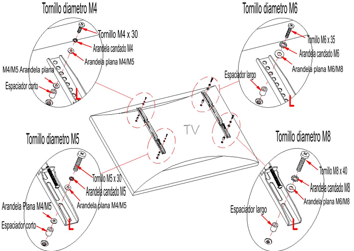
26. Determine el diámetro correcto de tornillos que utilizará en su televisión atornillando con sus manos para asegurar que entren bien, si encuentra resistencia detengase inmediatamente. Si no encuentra el tornillo adecuado dirígase a su tienda de ferretería local para el mismo.
