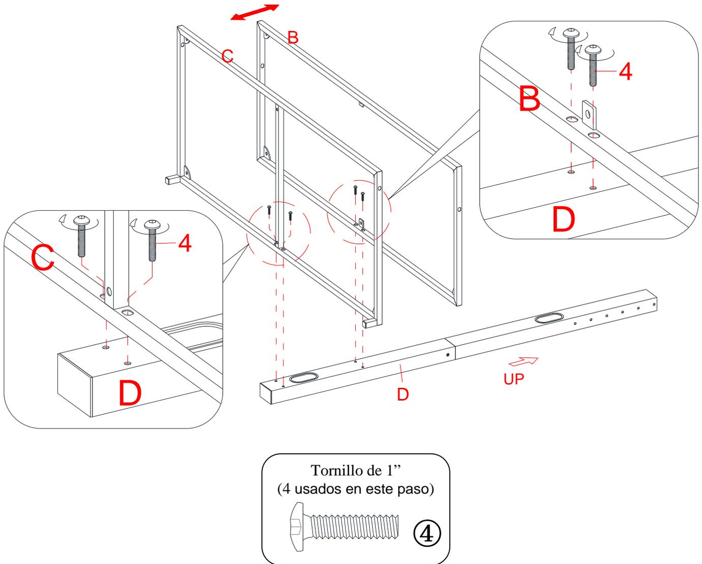
**NOTA:** Por favor no apretar todos los tornillos hasta que termine de ensamblar todas las piezas. Una vez montado, volver atrás y apretar todos los tornillos. Esto hará que el montaje sea más fácil.
