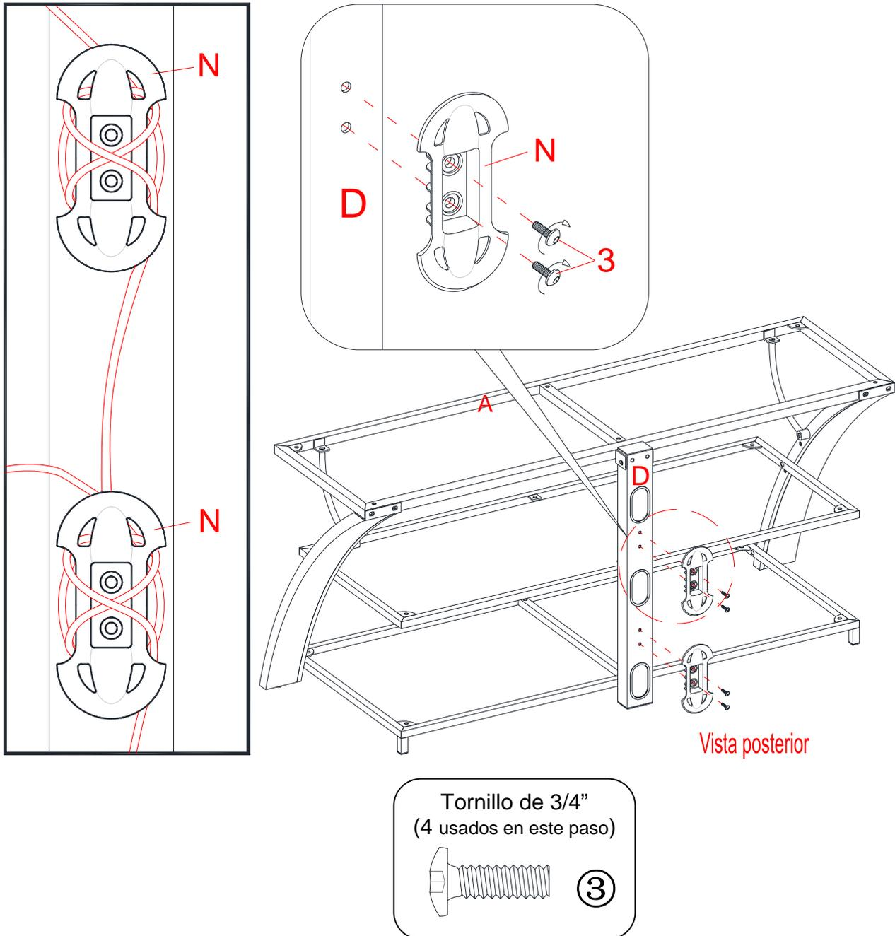
14. Coloque 2 guías para cable (N) a la parte posterior del poste inferior (D) con los tornillos de 3/4 "(3). Apriete los tornillos con la llave Allen suministrada.
