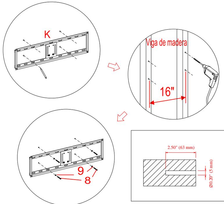
**NOTA:** Si esta montando esta TV a una pared con ladrillo, concreto o bloque de concreto, no continúe en esta sección. Este ensamblaje requiere un taladro eléctrico, nivelador y un localizador de barrotes (no incluidos).
