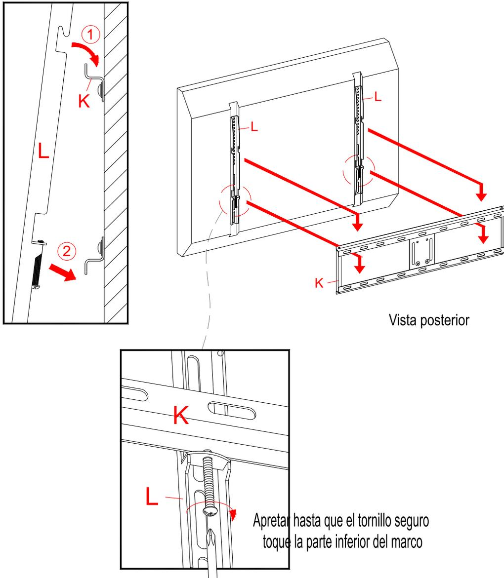
39. Fije los soportes de monitor (L) a la parte trasera del televisor siguiendo los pasos 24 y 25, o 26 y 27, dependiendo del tipo de TV que usted posee
