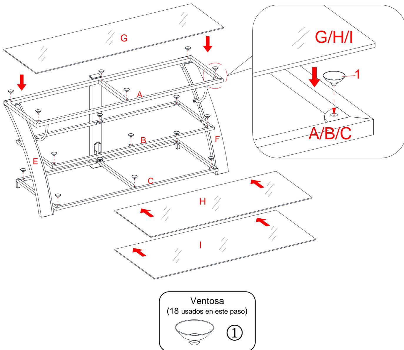
16. Coloque las ventosas (1) firmemente en los agujeros superiores y en el interior de las 3 repisas (A, B y C), como se muestra.
