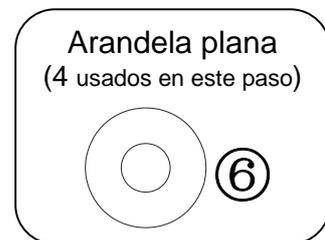
23. Mantenga y coloque el lado plano del marco de montaje (K) en el soporte giratorio (J) utilizando cuatro tornillos de 1/2" (2) y cuatro arandelas (5 y 6). Asegúrese de que los orificios avellanados del marco están en la parte inferior.
