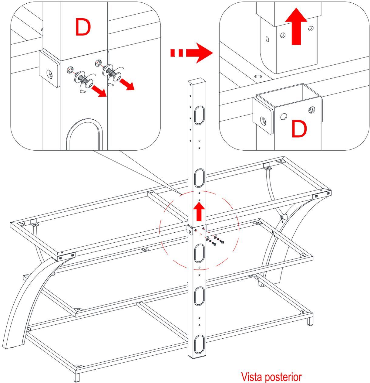
11. En la parte de atrás del poste (D), desenroscar los dos tornillos y las arandelas y quitar la parte superior. Así que usted puede utilizar la configuración de la consola tipo mesa.
